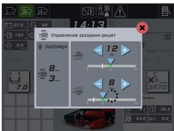
Рисунок 23. Окно «Управление зазорами решет» при авторегулировке зазора нижнего решета
