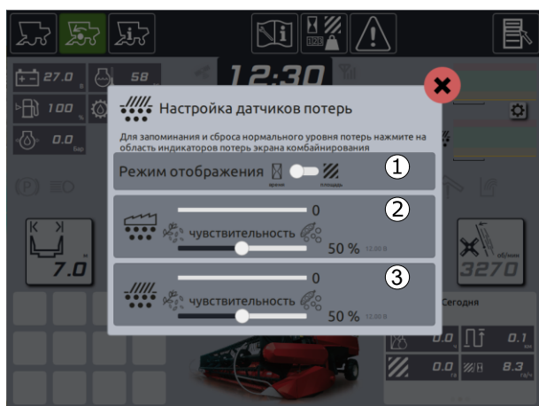
Рисунок 12. Окно «Настройка датчиков потерь»
