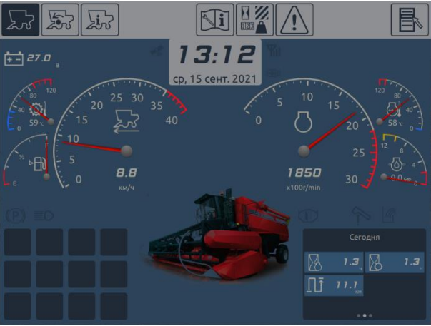
Рисунок 71. Экран «Движение» при отображении в ночном режиме
