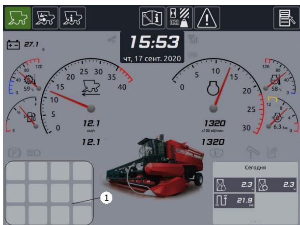
Рисунок 26. Зона вывода аварийных пиктограмм в режиме движения
