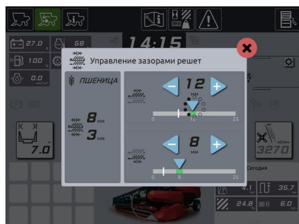
Рисунок 22. Окно «Управление зазорами решет» при авторегулировке зазора верхнего решета
