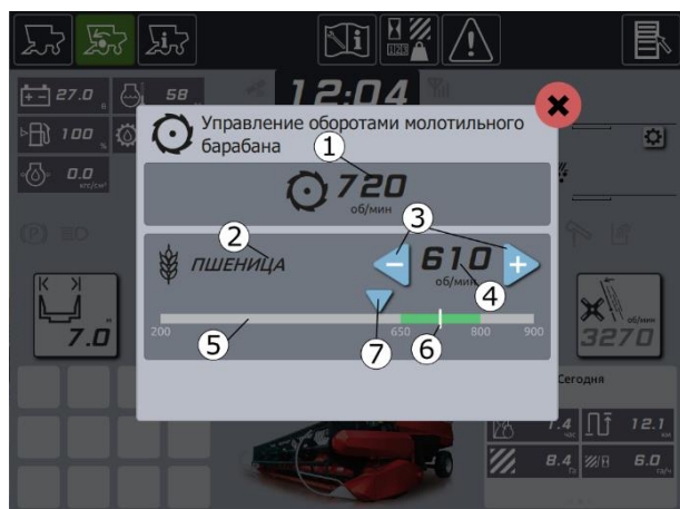
Рисунок 15. Окно «Управление оборотами молотильного барабана»
