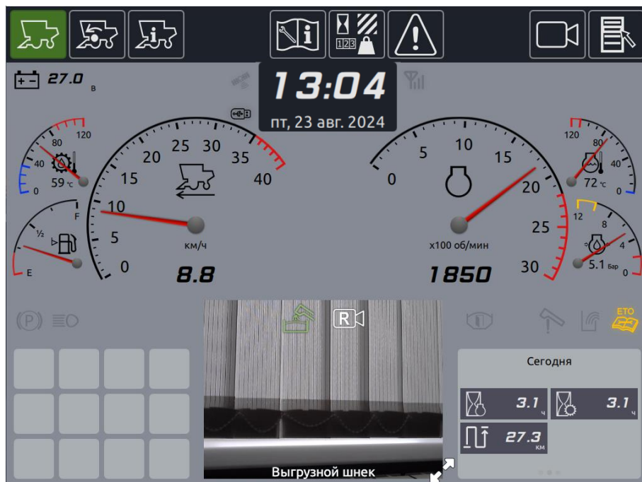
Рисунок 46. Отображение видео в режиме «Движение»
